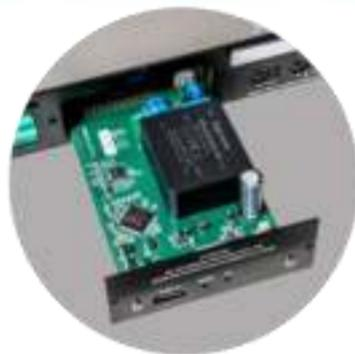
市场上唯一具有热插拔控制板的MDU，用于现场硬件升级。
